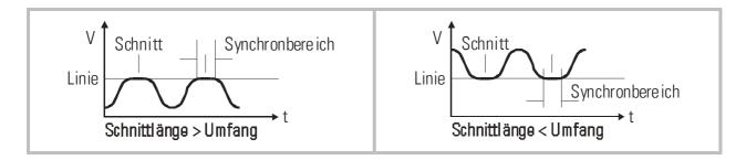
Durch das automatisch optimierte S-Profil treten zu keinem Zeitpunkt stoßartige Kräfte oder Drehmoment-Sprünge auf, was sich einerseits positiv auf die Schnittgenauigkeit auswirkt, andererseits selbst bei hohen Taktzahlen einen weichen, mechanikschonenden Maschinenlauf gewährleistet.
