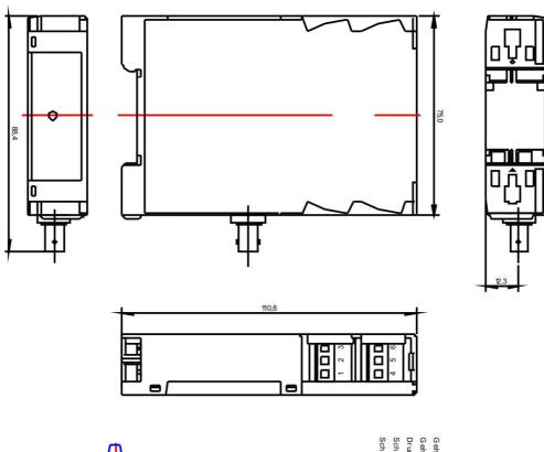
Geräuse material: Polyamid PA 6.6, UL 94 VO Geräuse far be: h eligrau, RAL 7 035 Druck far be: schwarz Schutzart Gehäuse: IP 40/EN 6 052 9 Schutzart Klemmen: IP 20/EN 60 529
