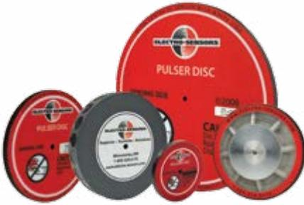
Monte na extremidade de um eixo de rotação e trabalhe com sensores de velocidade de eixo da Electro-Sensors. A montagem requer perfuração central e rosqueamento do eixo para um parafuso com fenda 10-32 UNF (fornecido).
