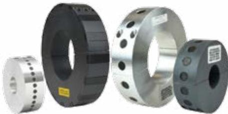
Fixe em torno de um eixo de rotação e trabalhe com sensores de velocidade de eixo da Electro-Sensors. Eles são ideais para instalações onde a extremidade do eixo é inacessível. As duas metades se prendem ao redor do eixo com parafusos de cabeça Allen cruciformes (fornecidos). Os modelos personalizados acomodam qualquer diâmetro de eixo, espaços apertados e chavetas.
